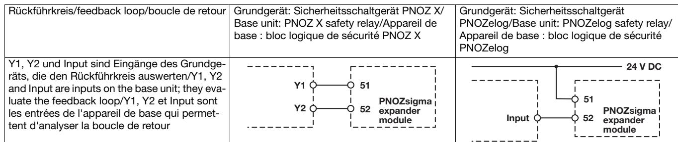
► Anschluss an PNOZsigma Grundgerät
