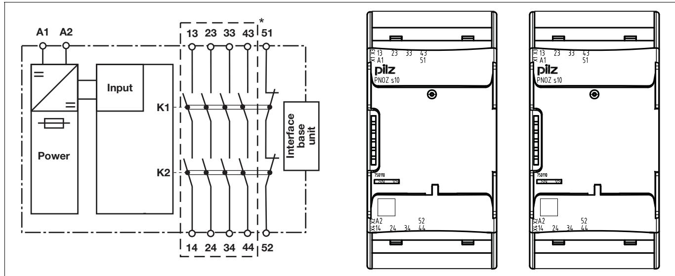
\*Sichere Trennung nach EN 60947-1, 6 kV
