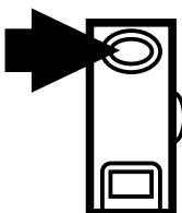
Die rote LED beginnt nach 2s schnell zu blinken. Danach blinken die LEDs gelb und grün im Wechsel. Nach 10s erlöschen alle LEDs, die Ausgangsfunktion hat von Hellschaltend auf Dunkelschaltend gewechselt (oder umgekehrt).
